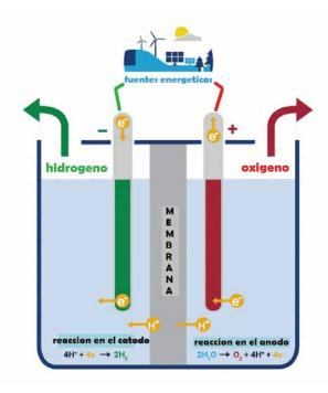
El agua utilizada para la electrólisis debe estar libre de minerales y contener algún tipo de electrolito para conducir la electricidad.
