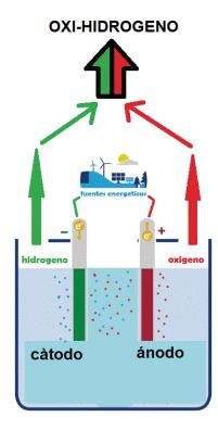
**OJO:** El gas de oxígeno e hidrogeno vienen juntos como un solo gas. ¡El HHO **NO** se puede comprimir y almacenar, ya que inmediatamente explotara!
